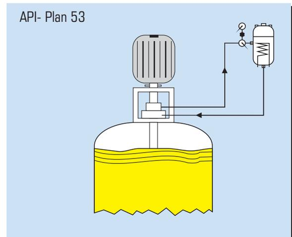
Depósito de fluido externo a presión 2 bar por encima de la presión del recipiente.
