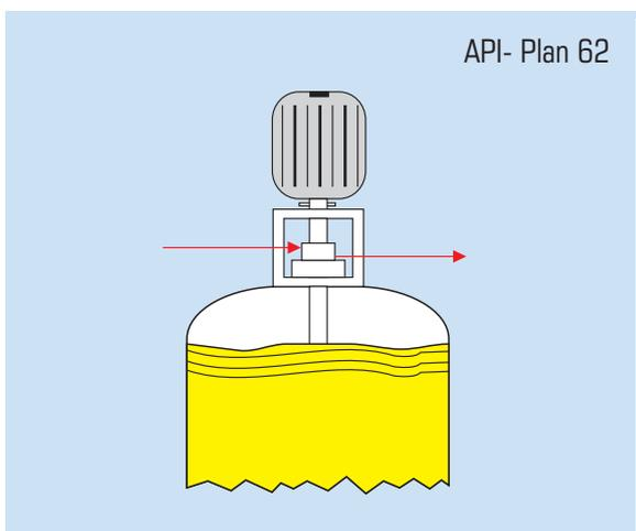
Inyección con fluido externo sin presión.
